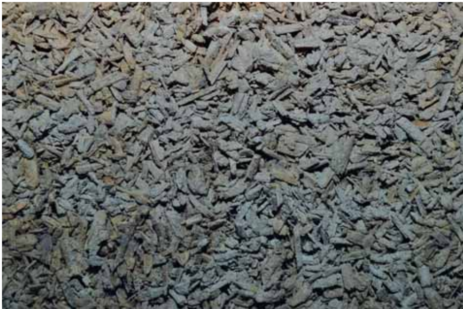
De eigenlijke depots worden gerealiseerd volgens het doos-in-dooisprincipe. De 'dozen' hebben een staalskelet, betonnen vloeren en wanden in kalkhennep (detail).
